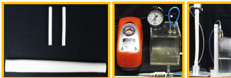
Figuras 1,2 e 3: Corpos de prova e tubo de silicone, aparato desenvolvido para bombeamento suave, registro e controle da pressão interna, pressurizador, recipiente primário, recipiente com água sob pressão.
