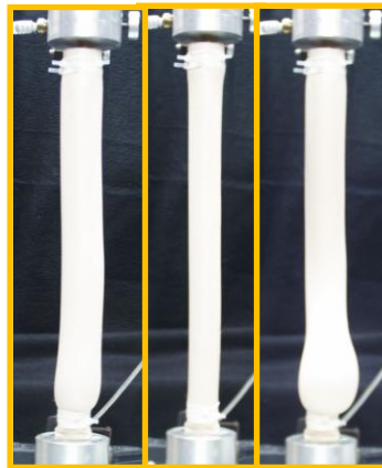
Figura 3: Sequência da pressurização do tubo de silicone sem tração, pressões em (mmHg).
