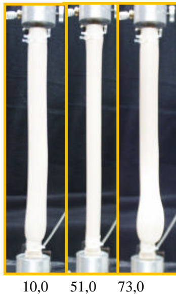
Figura 3: Sequência da pressurização do tubo de silicone sem tração, pressões em (mmHg).
