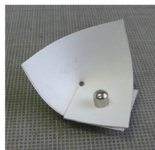
Figura 6 “Ponto zero” cortado em PVC e montado com parafuso e porca
