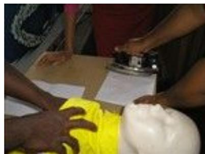
A borracha EVA é cortada em forma de máscara e colocada entre duas folhas de papel ofício. Assim a máscara será passada com ferro de uso doméstico.
