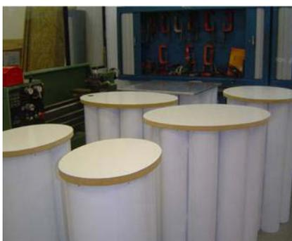
**Foto 29** A modularidade obtida com os pedestais não pôde ser alcançada nesse sistema sem perder o baixo custo. Então cada tampo de MDF era cortado exclusivamente para cada produto a ser exposto.
