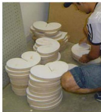
**Foto 26 Foram desenvolvidas peças de encaixe para dar estabilidade no sentido horizontal e fixar os tampo nos pedestais.**
