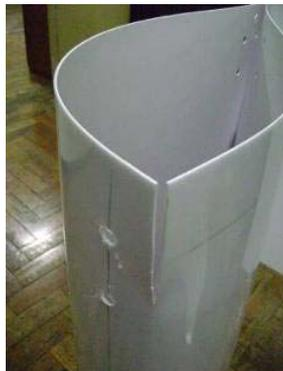
**Foto 22 rachadura oriunda da extrapolação dos limites de flexibilidade da chapa**
