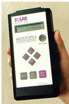
**Ilustração 4: Fotômetro solar portátil utilizado no projeto.**
