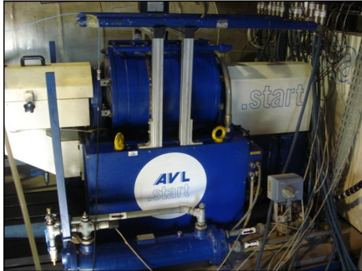
Fig. 3: Dinamômetro
