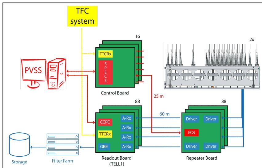
Fiz parte do Commissioning Group que é responsável pela verificação e instalação dos componentes do VELO. Participei de atividades para testar separadamente cada placa e cabo por meio de testes: simulação de aquisição de dados pelas placas de saída (TELL1), configuração do sistema pelas placas de controle (Control Board), sincronização dos tempos de chegada dos dados às placas devido a diferentes tamanhos de cabos e a checagem de cabos.
