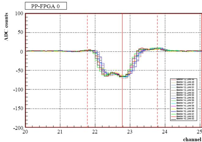
Para o teste dos cabos configuramos os módulos para enviar teste de pulsos como representação do número do bit do link e do módulo. Assim pudemos fazer uma comparação entre o número do link com o padrão do bit como visto abaixo. Em caso de algum problema nos cabos era possível defeitos na curva.
