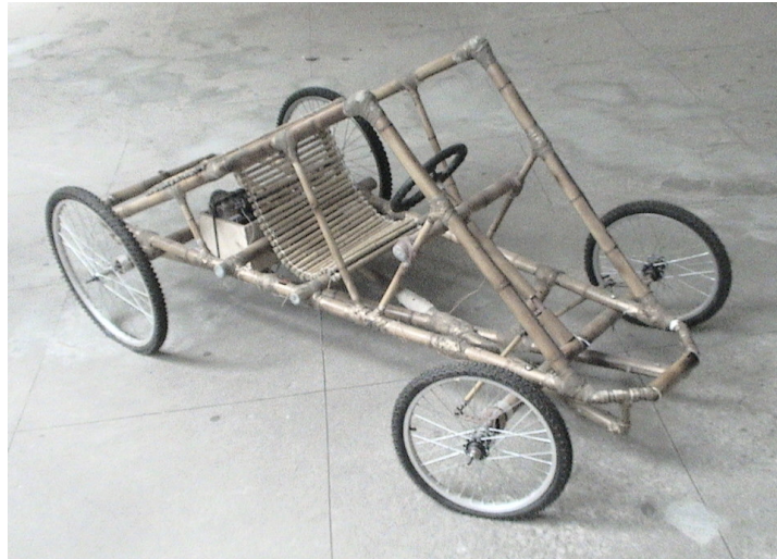
Figura 1: Veículo de bambu construído e em funcionamento.
