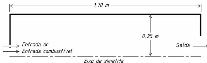
**Figura 1** Esquema simplificado da caldeira.
