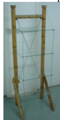
b) Modelo estrutural tensigríd de bambu com cabos de aço.
