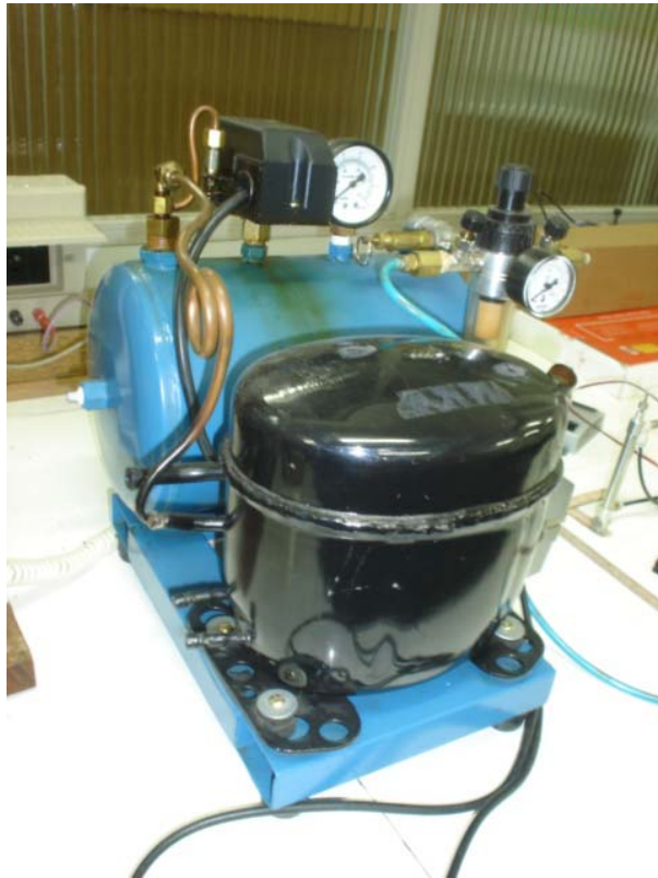
Figura 3.10 Compressor utilizado para alimentar o sistema
