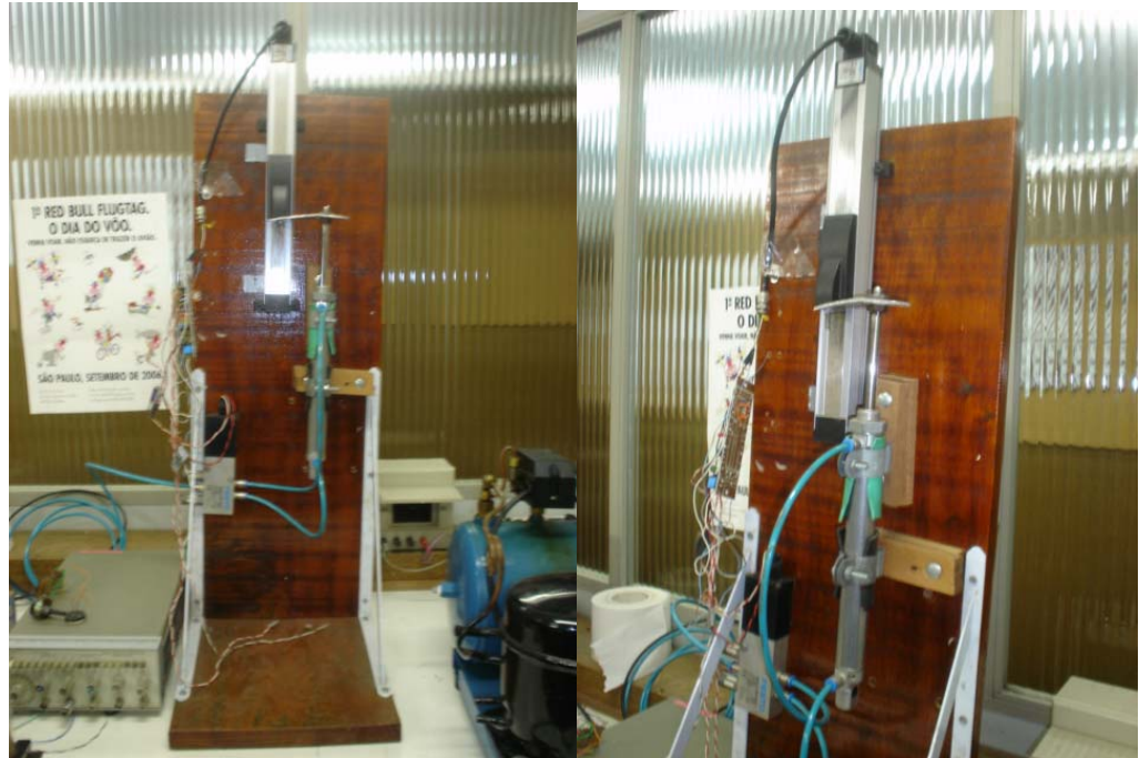
Figura 3.1 Conjunto válvula-atuador pneumático-transdutor já desenvolvido
