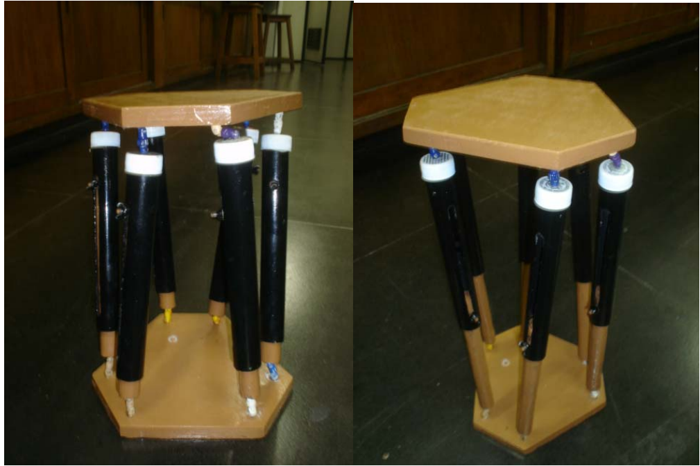
Figura 4.2 Protótipo construído - posição mais baixa e mais alta sem rotação
