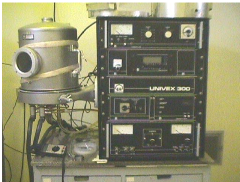
Figura 3 – Univex 300, onde realizamos as deposições de materiais orgânicos para a produção de OLEDs.
