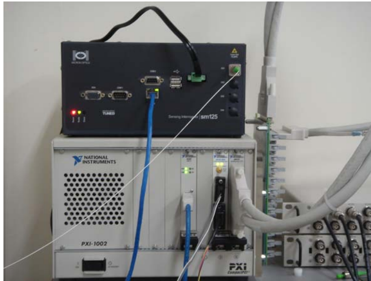
Figura 4. Em cima um interrogador de redes de Bragg da Micron Optics e em baixo uma ponte de Wheatstone da National Instruments
