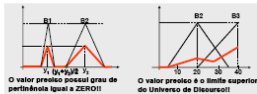
Figura 18: com o método Média dos Máximo, a saída precisa é dada através da média dos maiores valores da função de pertinência do conjunto de saída
