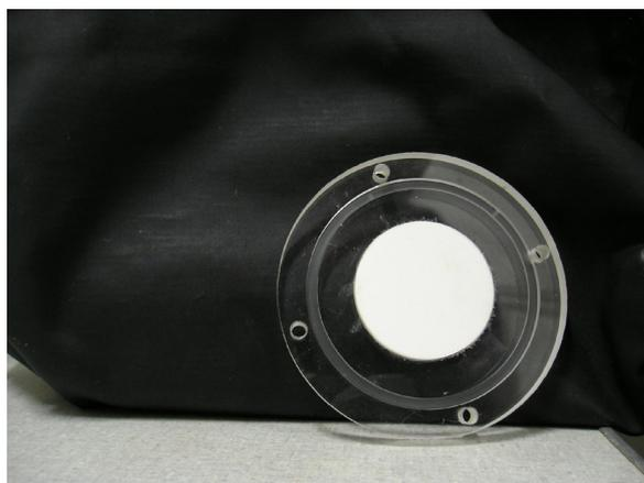
**Figura 3.3** Disco contendo a placa de vidro porosa usada para produzir as bolhas de ar
