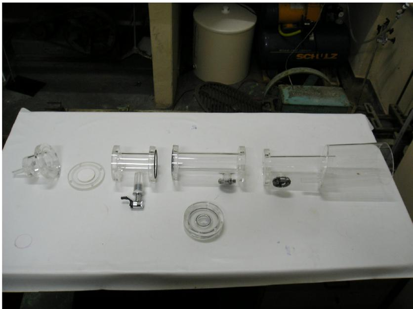
**Figura 3.2** Principais partes da coluna de bioflotação
