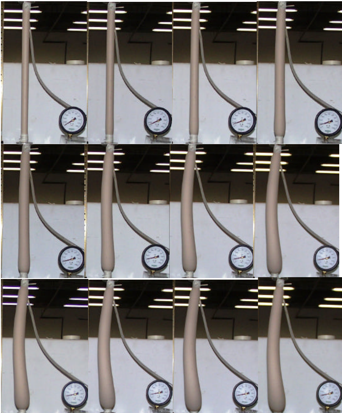
foto6: devido a tração o tubo apresenta pequena flambagem
