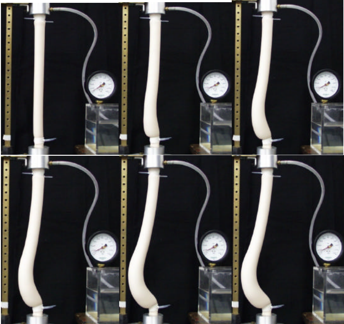
foto11:note que no tubo sem tração e pré-condicionamento o bulbo é bem localizado e há flambagem acentuada
