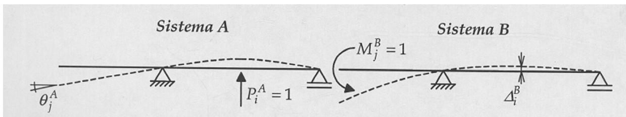
Figura 1 – Teorema de Maxwell para forças generalizadas unitárias.
