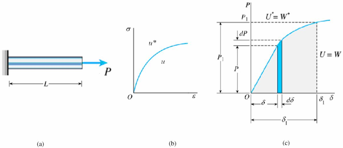
Figura 2 – Energia de deformação e energia complementar
