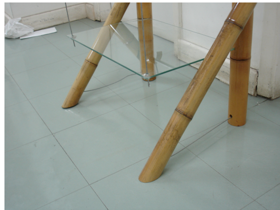
Fig. 8 e 9 – Modelo estrutural tensigrity de bambu com cabos de aço. Tensoestrutura.
