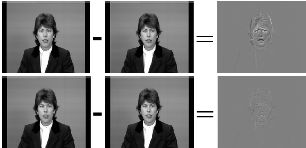
Figura 3.1: Diferença entre quadros; (em cima) sem compensação de movimentos; e (embaixo) com compensação.
