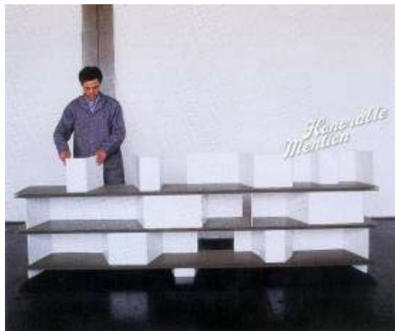
Foto 101 - Blu Dot's ready-to-assemble shelving (Prateleira pronta para montar) é baseado em uma mobília de dormitório de faculdade: bancada de tijolos empilhados. A prateleira de metal perfurado é apoiada em divisórias feitas de folhas dobradas de polipropileno, que podem ser facilmente cortadas com uma faca olfa. Imãs colocados dentro do polipropileno fazem com que as divisórias grudem na prateleira de metal. (Página 151, I.D. The International Design Magazine, July / August 2004)
