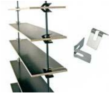
Foto 84 - Estante de Milos Sous: a “alma” do produto são as conexões, desenvolvidas com base em grampo para instalação de forros de telhado. As prateleiras são instaladas nas barras de aço com grampos que funcionam por pressão: quanto maior o peso na prateleira, mas resistente fica a conexão (Página 47 Arc Design nº 44, 2005)
